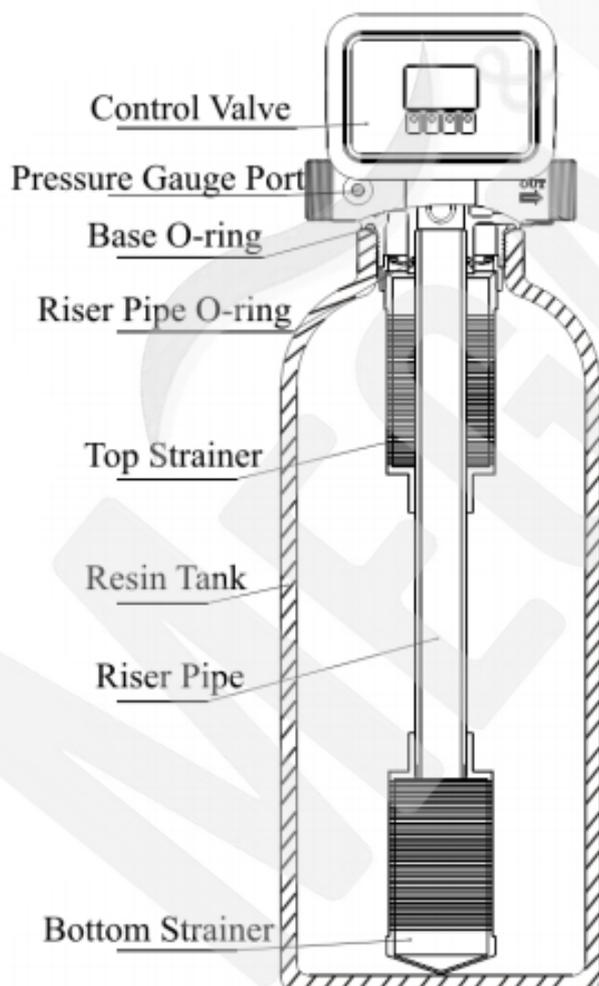
La multiválvula automática para filtro F134A funciona con un ratio de flujo de 8m<sup>3</sup>/h y tiene una junta resistente a la corrosión para su apertura y cierre respectivos. Gracias a la modificación de los parámetros de la válvula, se pueden realizar funciones de servicio, de descarga inversa y de descarga rápida.
